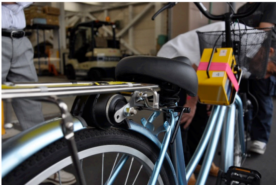
ザンビアでの利用感想に対応し、ハブダイナモを利用した負荷の少ない第二次改良型人力発電自転車を開発
