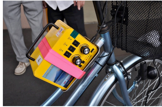
バッテリー設置場所の改良工夫により、より安定した走行ができる改良型人力発電自転車
